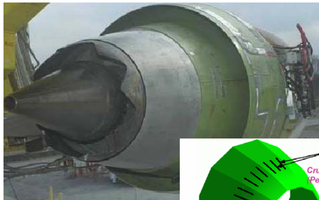
«Шевронное» сопло, управляемое материалами с памятью формы.
